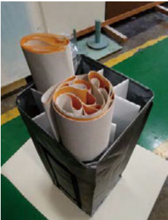
養生ボックスへの過度な詰め込み
